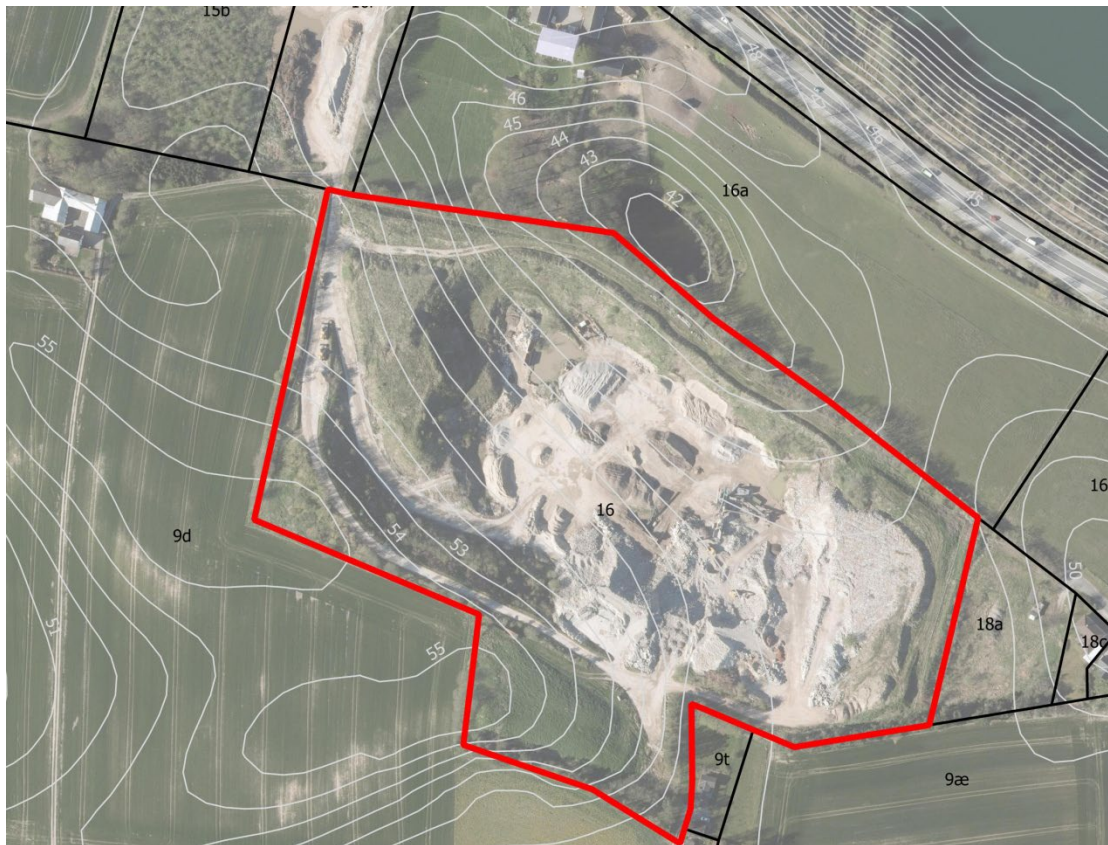
Figur 3.8 Terrænforhold efter opfyldning og slutafdækning
